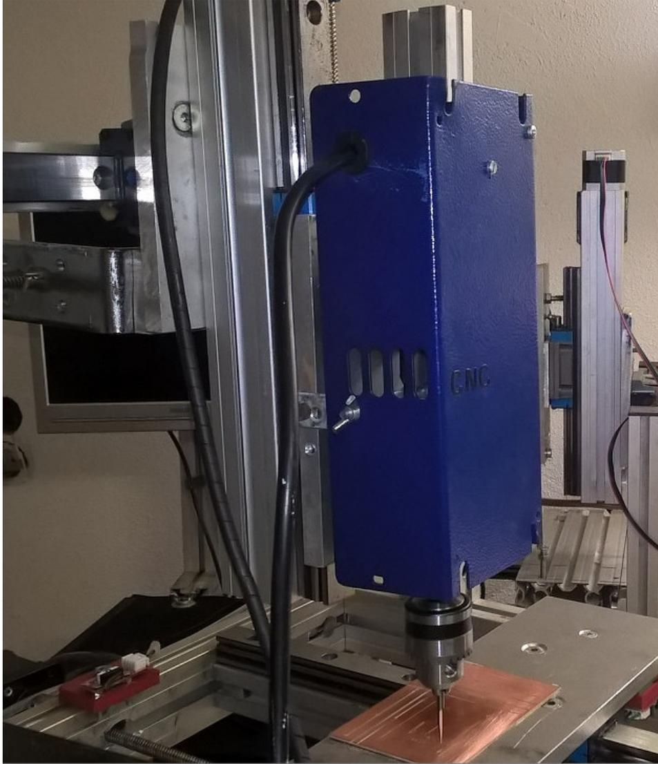
**Z – Achse mit DC 12V -32V Drehmaschine 555 Motor mit Miniatur Handbohrfutter**
